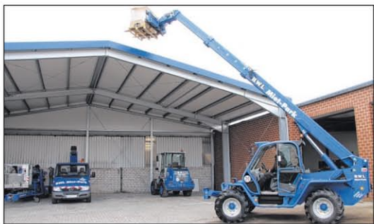
Neu: Der Teleskopklader reicht fast 14 Meter hoch.
